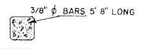
SECTION B-B SCALE: 1" = 2' 0"
